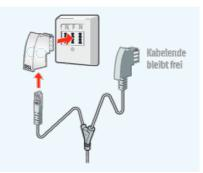
Stecken Sie das lange Ende des Y-Kabels an der FRITZ!Box in den grauen Steckplatz DSL/TEL.
